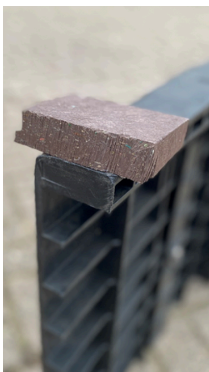
Afbeelding 3 - Hoogwaardige, postindustriële gerecyclede HDPE vs laagwaardige, post-consumer gerecyclede mixstroom
