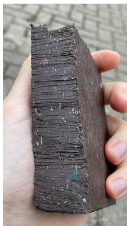
Afbeelding 5 - Close-up laagwaardige, post-consumer gerecyclede mixstroom
